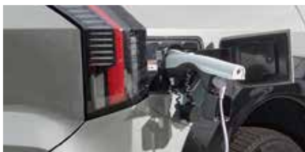
Функция передачи энергии снаружи (V2L)
